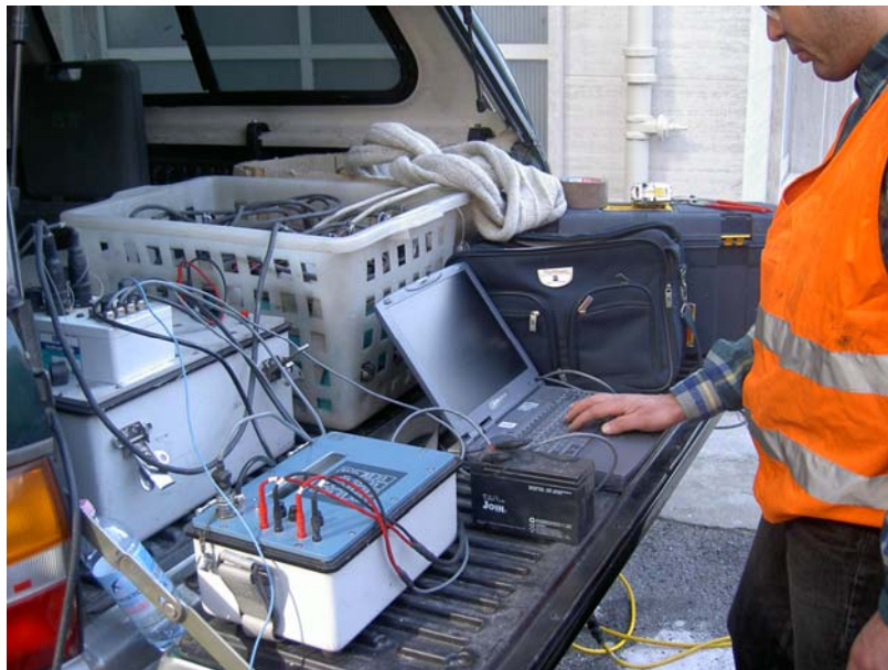
fasi di prospezione geologica preventiva alla progettazione di un microtunneling effettuata con il sistema di indagine geoelettrica
