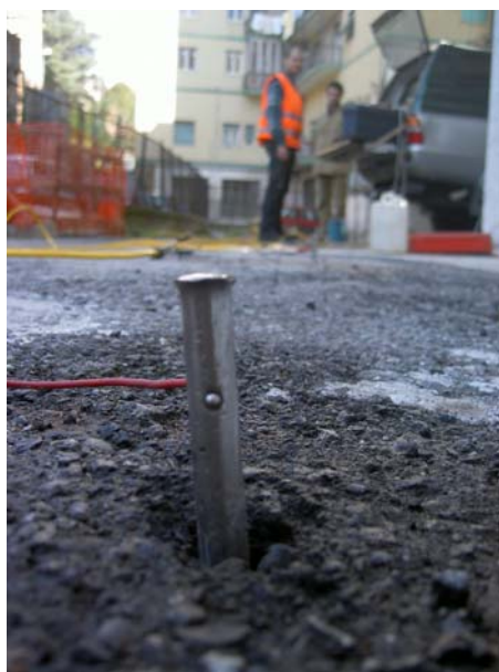
fasi di prospezione geologica preventiva alla progettazione di un microtunneling effettuata con il sistema di indagine geoelettrica
