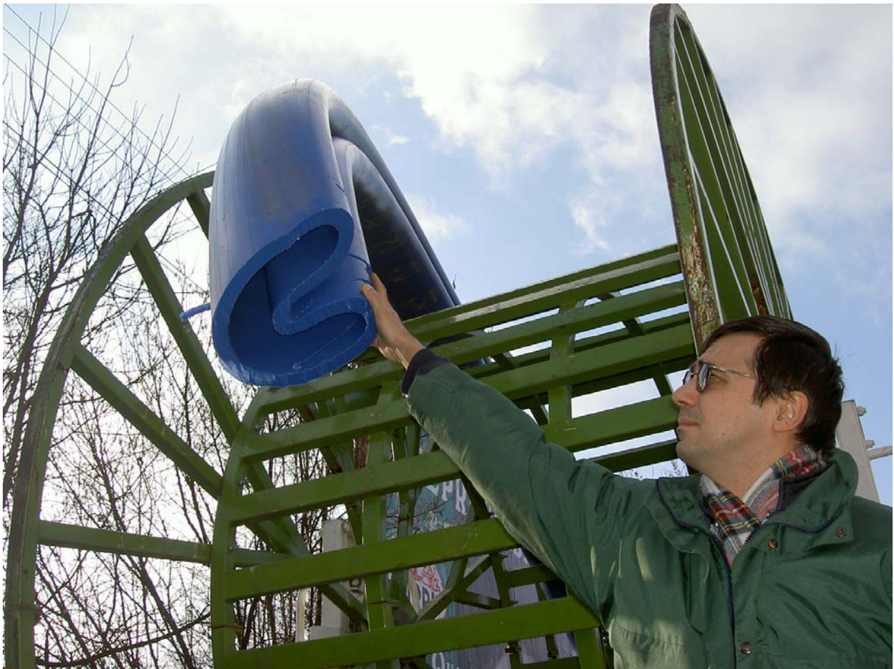
sezione e bobina di trasporto di un tubo Compact Pipe in PE100 per il rinnovamento close-fit di condotte idriche DN 400 PN10.
