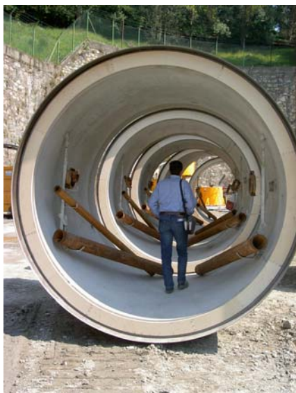
conci di grande (D. esterno 3000 mm) e di piccola (D. esterno 400 mm) dimensione
