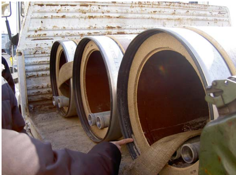
conci di grande (D. esterno 3000 mm) e di piccola (D. esterno 400 mm) dimensione
