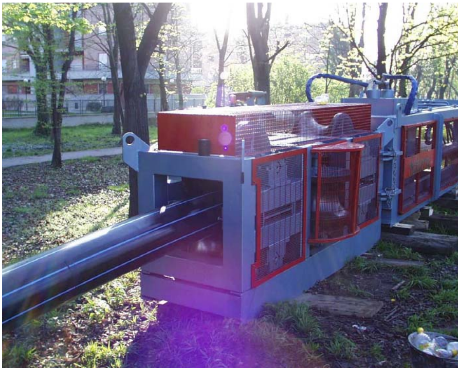
macchina Roll-Down per la riduzione del diametro di condotte in PEAD
