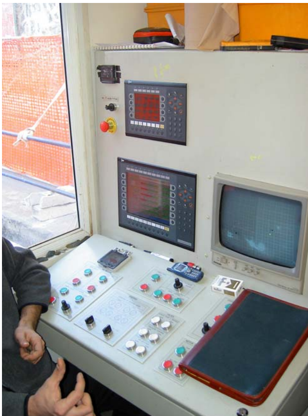
Sistema di guida e di controllo remoto della perforazione. Fase di direzionamento laser di un microtunneling di grandi dimensioni
